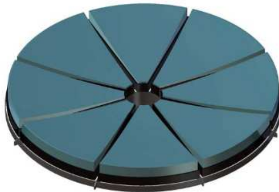
Figura 2.13: Progetto di lente ottenuta attraverso la composizione di 8 petali.
