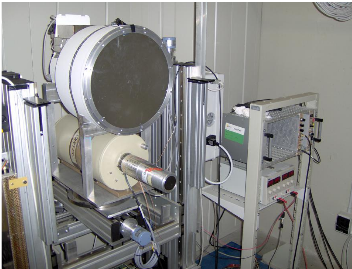
Figura 3.3: Vista del rivelatore per immagini Thales (sopra) e del rivelatore spettroscopico al germanio (sotto).
