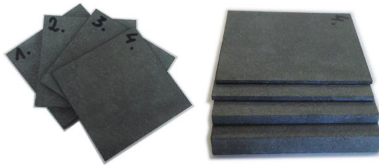
Figura 5.3: Campioni di CeSiC utilizzati per le misure numerati da 1 a 4. Veduta superficiale a sinistra, veduta di taglio a destra.
