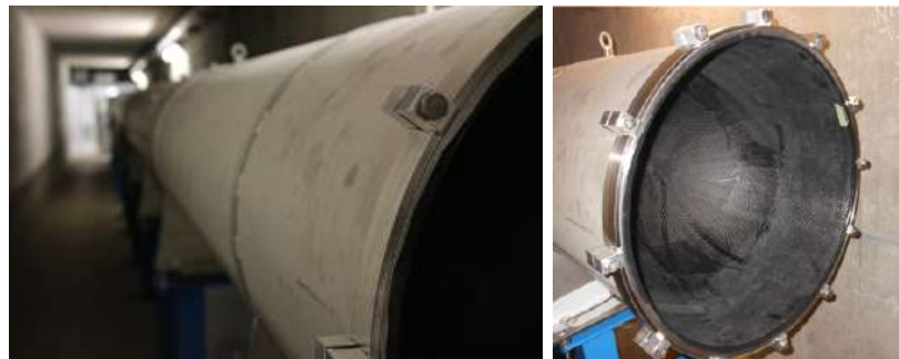
Figura 2.5: Cilindro in cui viaggia il fascio di raggi X e chiusura in fibra di carbonio.
