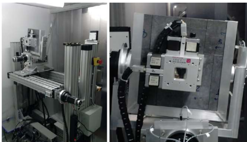
Figura 2.6: Collimatore usato nella camera bianca del tunnel del LARIX. A sinistra il collimatore é montato sul carrello, a destra un dettaglio della lame in tungsteno motorizzate.
