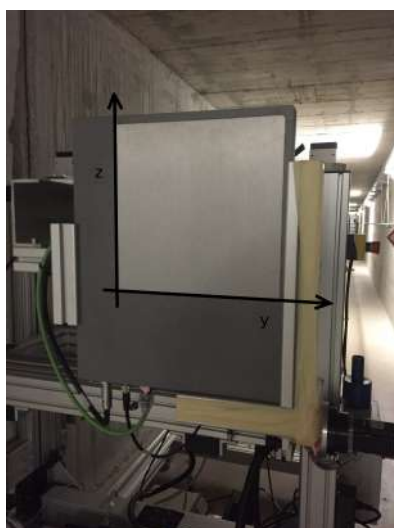
Figura 3.3: Il detector imager utilizzato per le tecniche di allineamento della beam-line e anche per l'allineamento dei singoli cristalli. In corrispondenza della superficie sensibile del rivelatore, sono disegnati gli assi di riferimento.
