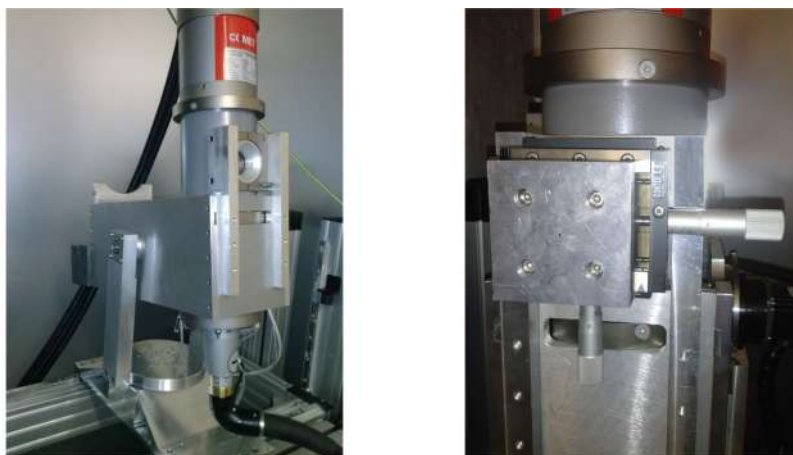
Figura 2.3: Sorgente di raggi X presente all'interno del laboratorio LARIX. Dettaglio del collimatore della sorgente.
