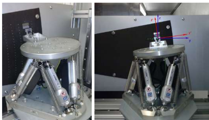
Figura 2.8: Immagini del esapode HXP utilizzato per l'allineamento dei cristalli dentro il laboratorio LARIX.
