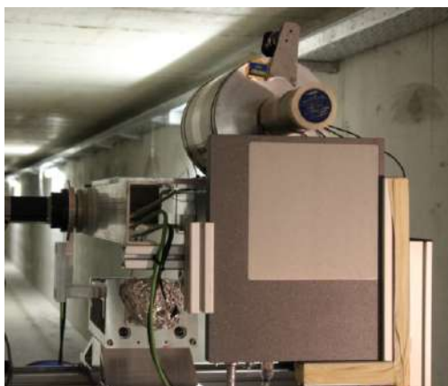
Figura 2.11: I due rivelatori utilizzati durante le procedure di allineamento: in alto lo spettrometro e in basso l'imager.
