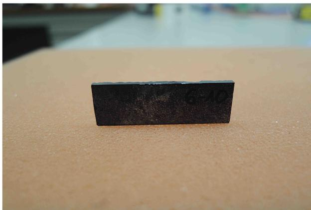
Figura 3.1: Cristallo di GaAs (220) (già sottoposto a lappatura per indurre la curvatura) impiegato nel prototipo di lente di Laue.
