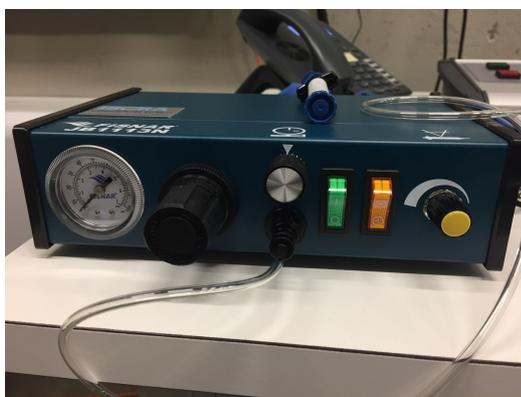
Figura 3.3: Il dosatore di colla utilizzato. Si possono vedere le due manopole con le quali vengono regolate pressione e temporizzazione.
